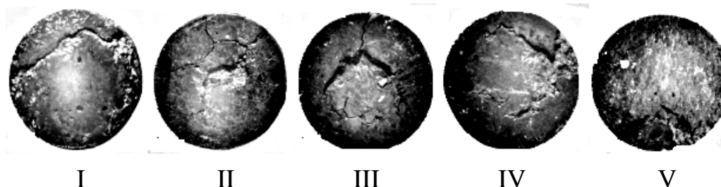
Рис. 3. Стадии разрушения наплавленного слоя при термоциклировании
