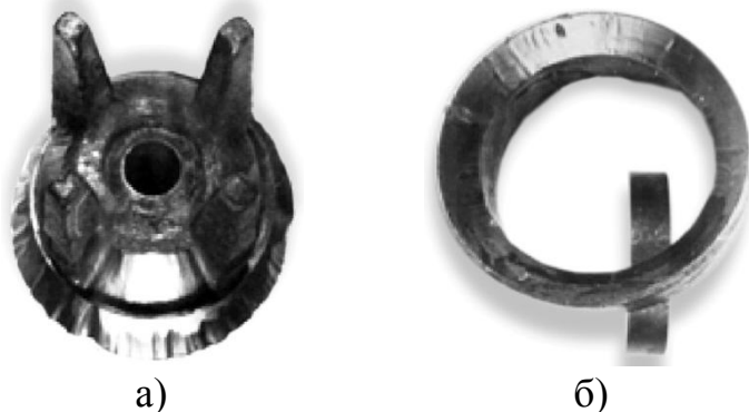
Рис. 6. Следы промывки буровым раствором на рабочих поверхностях тарелки клапана (а) и седла (б)
