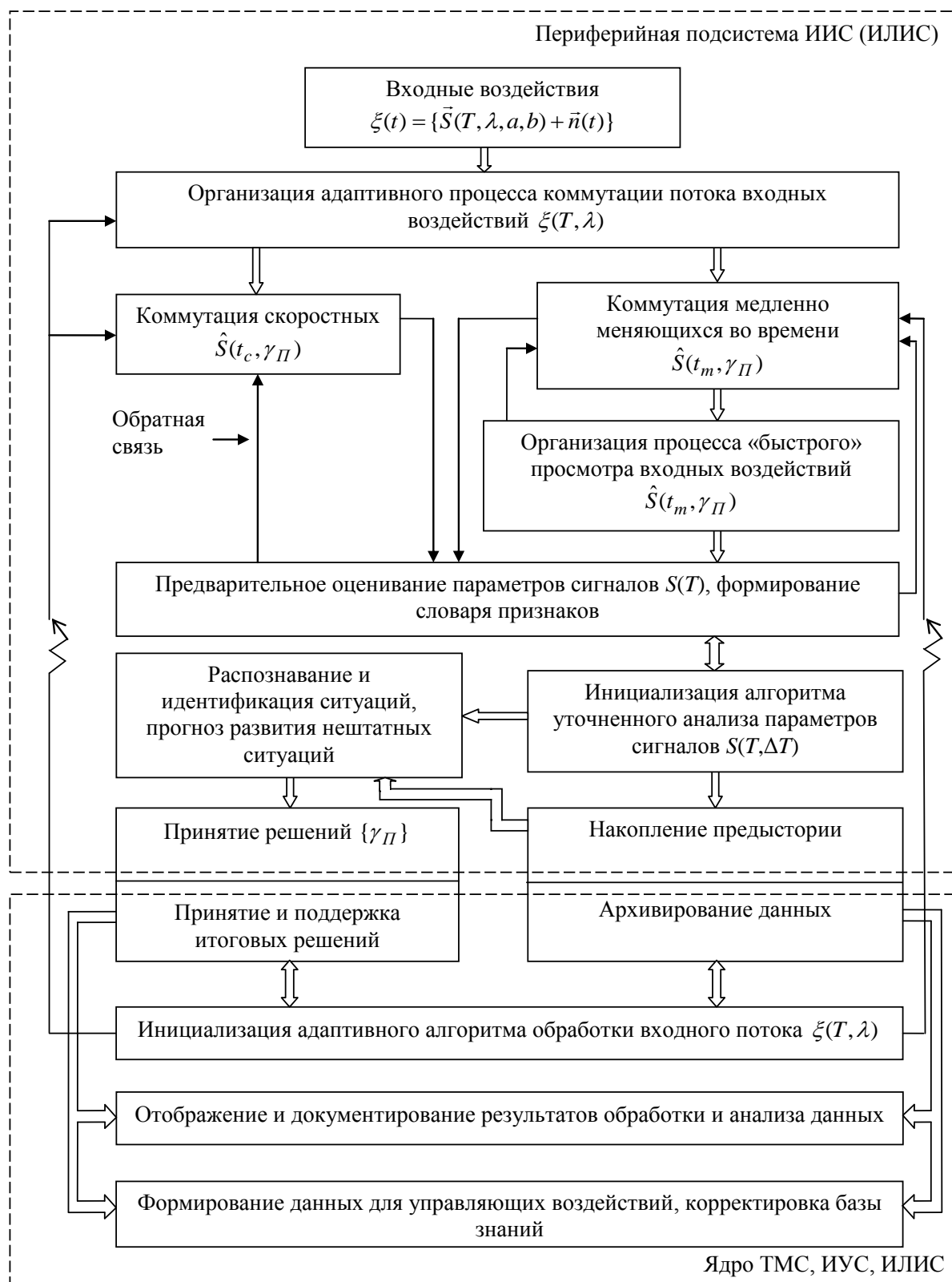
Рис. 2. Системная модель ТМС и её периферийной подсистемы
