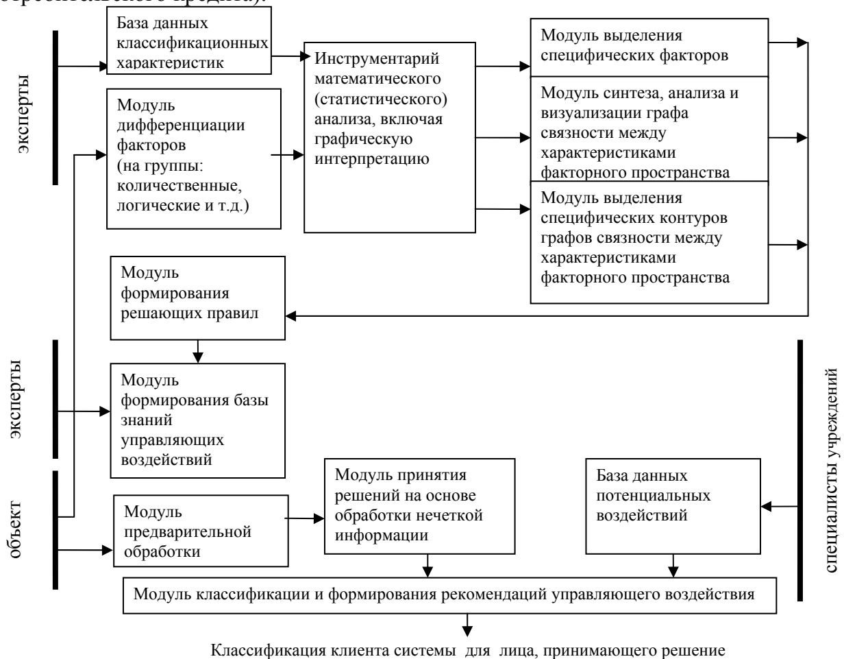
Рис. 5. Структурно-функциональная организация системы информационной поддержки принятия решения
