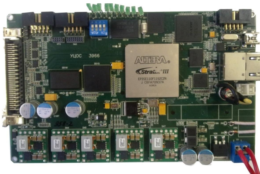
Рис. 3. Внешний вид модуля на базе устройства для классификации последовательности цифровых сигналов по заданным эталонным законам распределения
