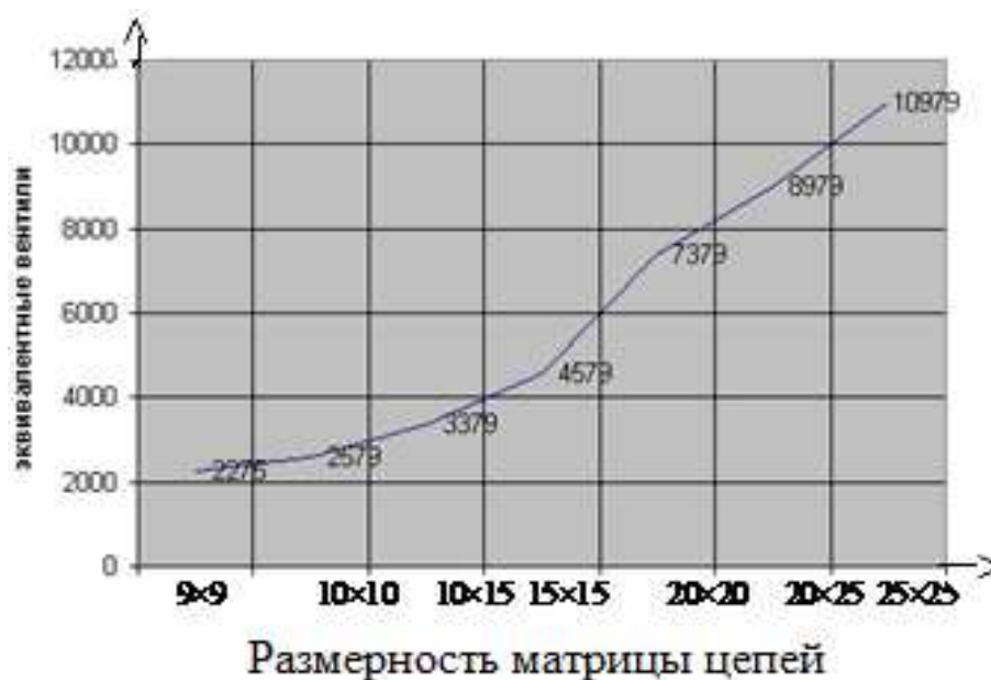
Рис. 8. Зависимость аппаратной сложности от размерности матриц цепей
