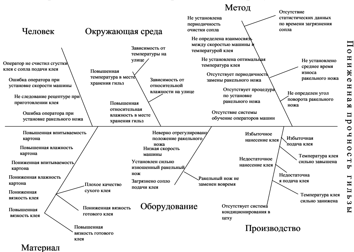
Рис. 6. Анализ причин пониженной прочности гильз при помощи диаграммы Исикавы
